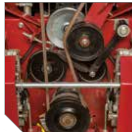
Meer dan 180 graden V-riemomwikkeling op aandrijving van aandrijfjas tot klepelrotor om de krachtoverbrenging op de rotor te garanderen. Rotoraandrijving door gekoppelde dubbele riem.
